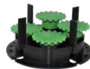
Stelzlager, Vollstück , höhenverstellbar von 35-50 mm, ergibt 2 mm breite Fugen. Höhe der Fugenstege kann individuell z. B. mit einem Seitenschneider gekürzt werden. Rand- und Eckstücke können herausgebrochen, bzw. geschnitten werden. (Nur für Granitkeramik-Platten geeignet)
